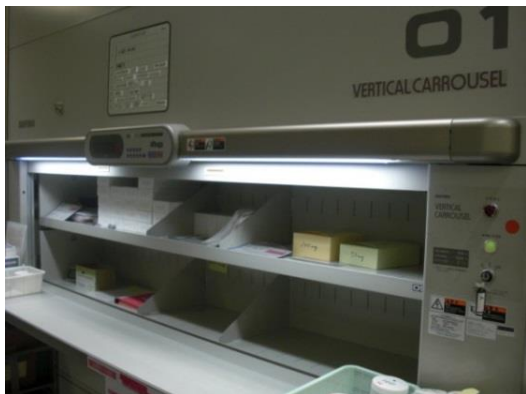
〈調剤室 バーチカルカルーセル〉
